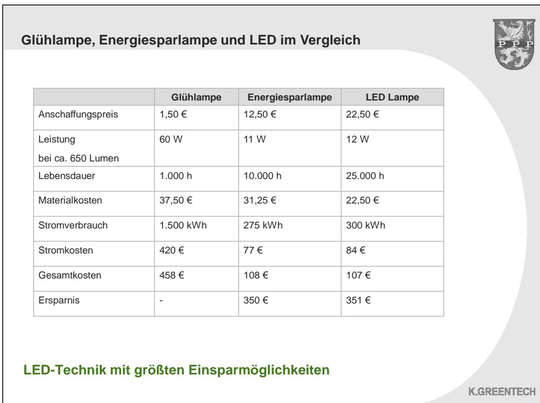
Abbildung 39: Glühlampe, Energiesparlampe und LED im Vergleich
